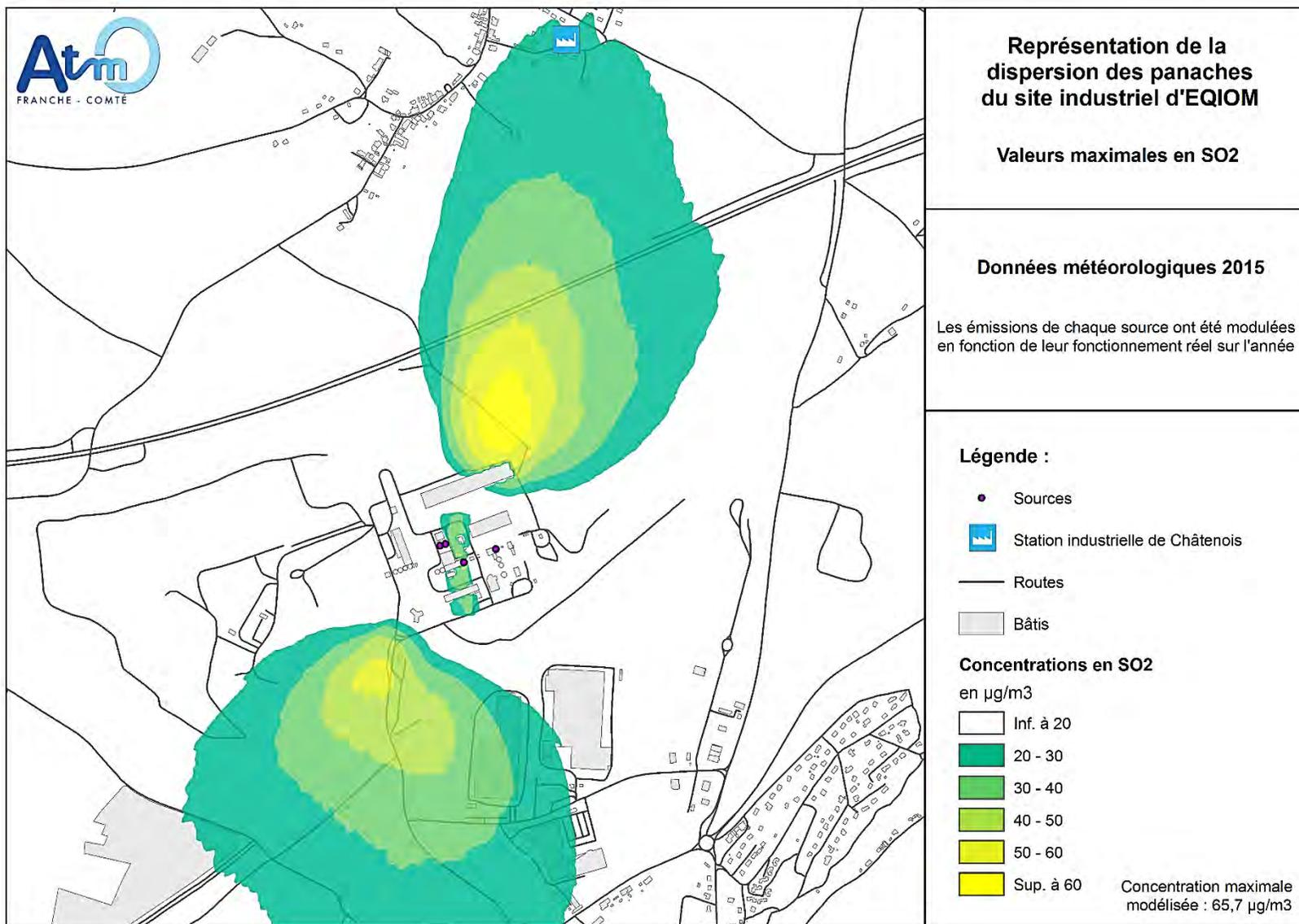
Figure 9 : Carte de modélisation des concentrations maximales modélisées en 2015 en dioxyde de soufre issues des panaches industriels
