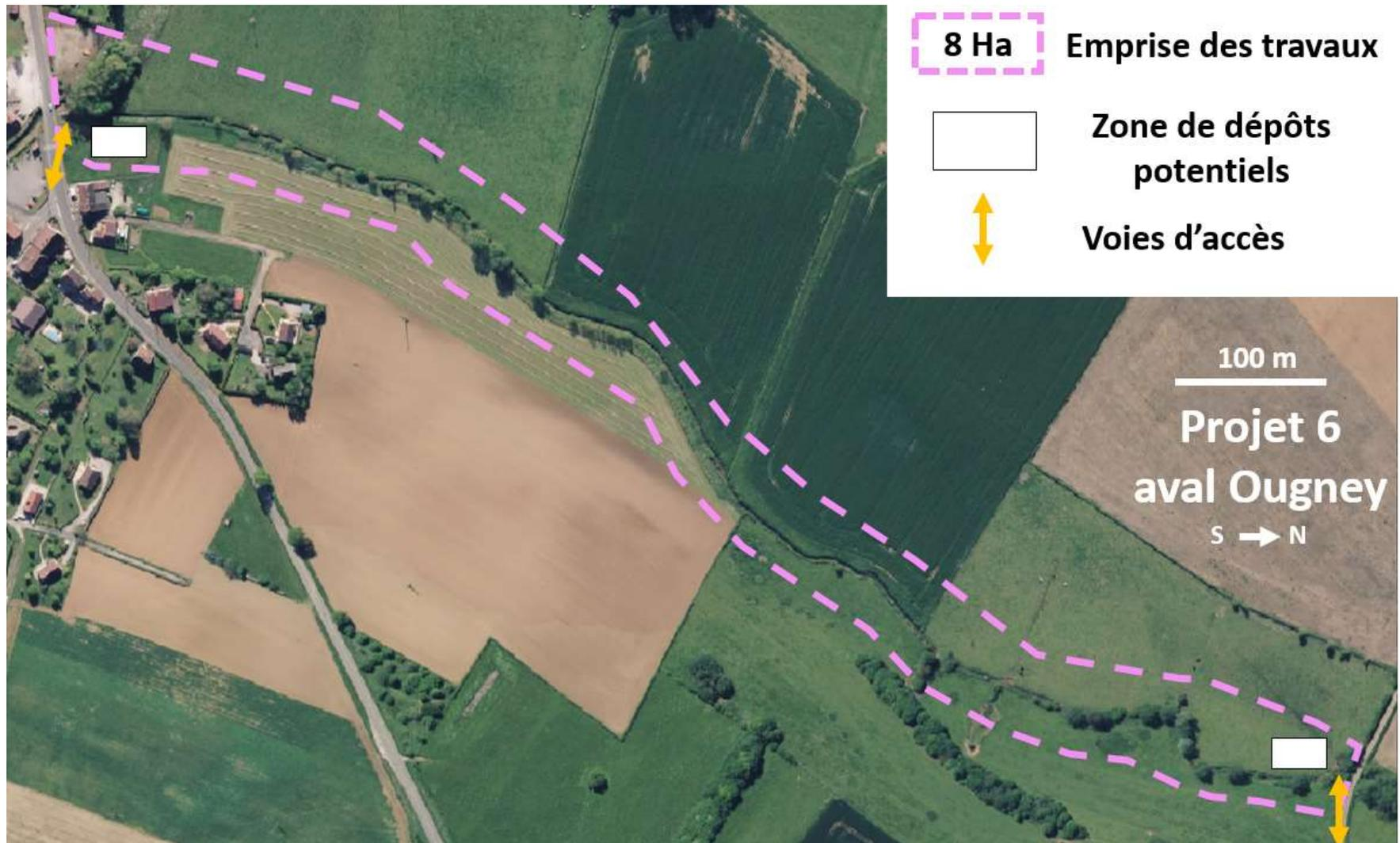
Figure 21.25 : Voies d'accès au chantier (flèches blanches) et zone de dépôts pressenties (carrés blancs) pour le projet « 6 Aval Ougney ».
