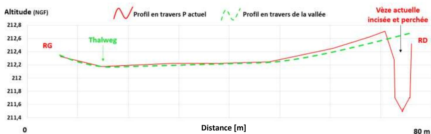
Figure 6.4 : Profil en travers actuel montrant le positionnement perché du lit de la Vèze actuelle.
