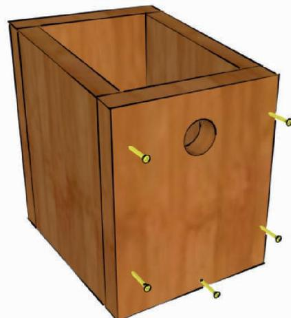
Placer l'avant. 2 vis pour chaque côté et 1 vis pour le fond.
