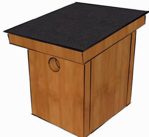
Éventuellement, pose d'une toile bitumée pour l'étanchéité.
