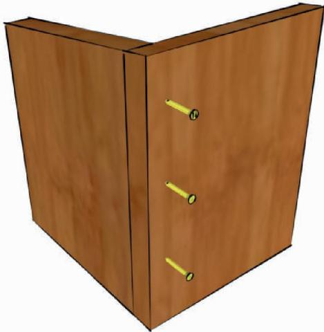
Assemblage de l'arrière et d'un côté avec 3 vis.
