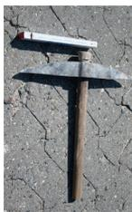
L'usage de l'escoude remonte à l'Antiquité. En frappant avec cet outil, le carrier fait une saignée dont la profondeur correspond à la hauteur de pierre désirée. Il délimite ainsi le contour du bloc, puis détache celui-ci de la roche à l'aide de coins en bois introduits à sec. Mouillés, leur gonflement fait éclater la couche de pierre et libère le bloc.
