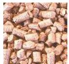
Ce combustible, très dense, dispose d'un pouvoir calorifique minimum de 4600 kWh par tonne avec une humidité sur poids brut du granulé de 8 %. Sa masse volumique est de 0,7 tonne/m<sup>3</sup> ce qui facilite le transport et le stockage. Le granulé se présente sous la forme d'un cylindre de 6 à 10 mm de diamètre et d'une longueur moyenne de 2 cm. Le prix généralement pratiqué est environ 130€ la tonne livrée par camion souffleur, selon la distance et la quantité, départ usine
